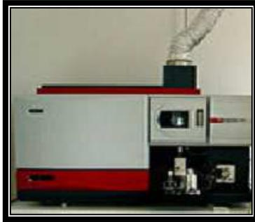
**Figura 16:** Aparelho ICP-OES do controle de qualidade do IPEN.
