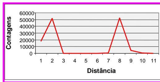
**Figura 23:** Cromatograma ITLC-SG do  $^{18}\text{F}$ -FDG +  $^{18}\text{F}^-$ , solvente 80% acetonitrila: 20% água.
