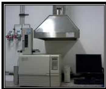
**Figura 17:** Cromatógrafo à Gás (Shimadzu), IPEN.
